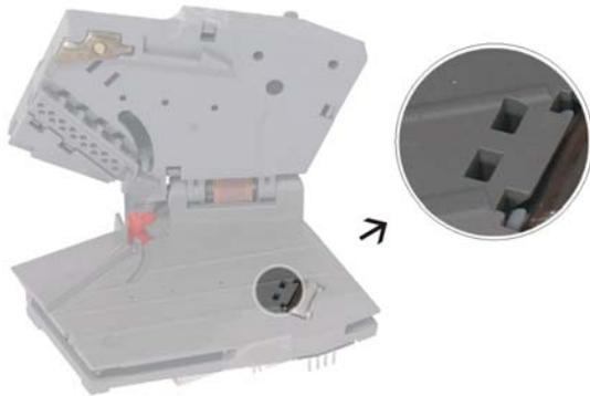
En la parte inferior del módulo de entradas se localiza el sensor acústico que tiene la misión de captar el sonido emitido por la moneda al rozar contra el cilindro *metálica* en su recorrido. Los parámetros recogidos por este sensor son muy importantes en el proceso de aceptación o rechazo de la moneda.
