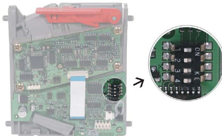
3º. Colocar un puente entre los pines 1 y 2 del conector de 4 vías J5. El *selector* indica que está en modo de "autoprogramación" activando el *electroimán* del *obturador* durante un breve espacio de tiempo (aproximadamente 100 milisegundos).
