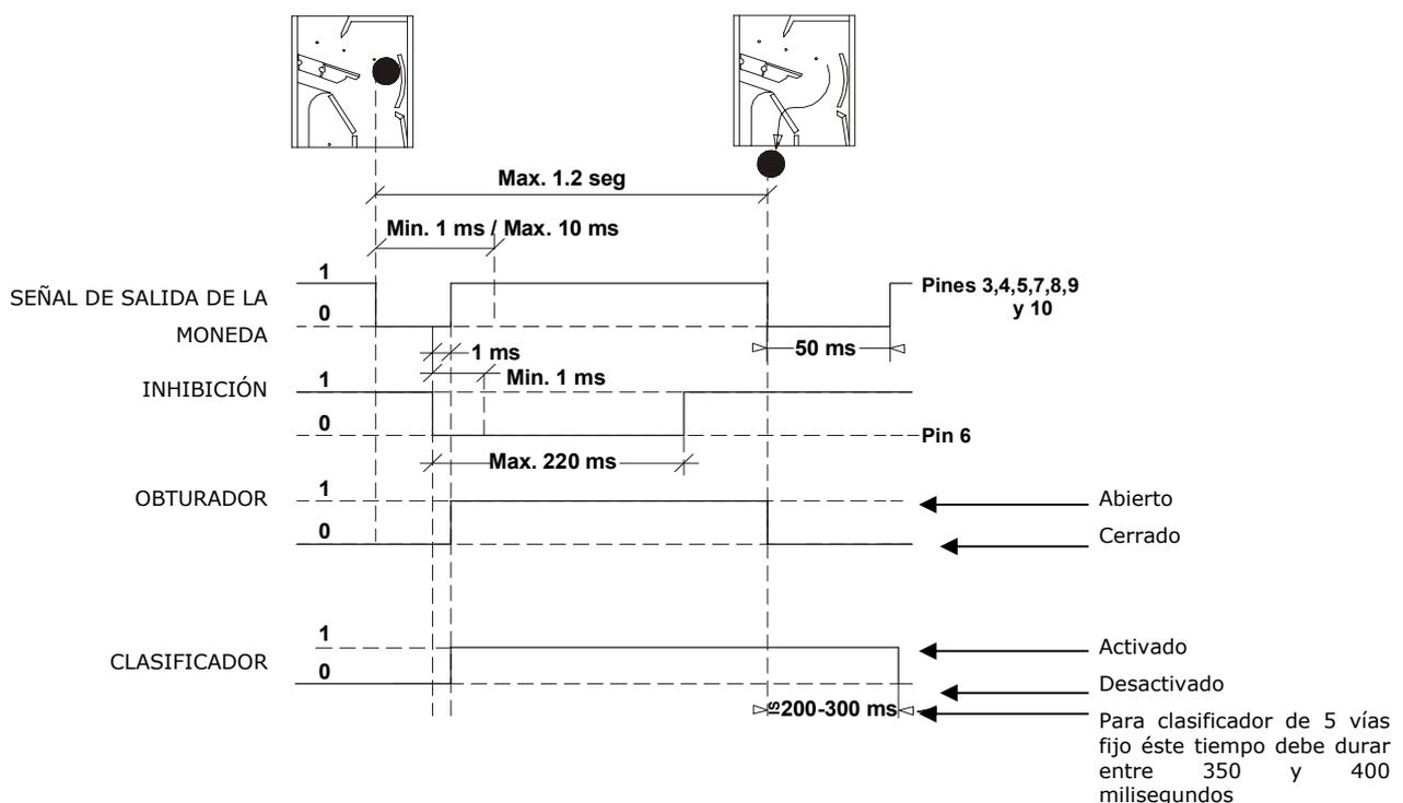
La FIGURA 1 muestra el instante en el que la moneda ha pasado por todos los sensores que se utilizan para su análisis y el *selector* inicia la comunicación con la máquina:
