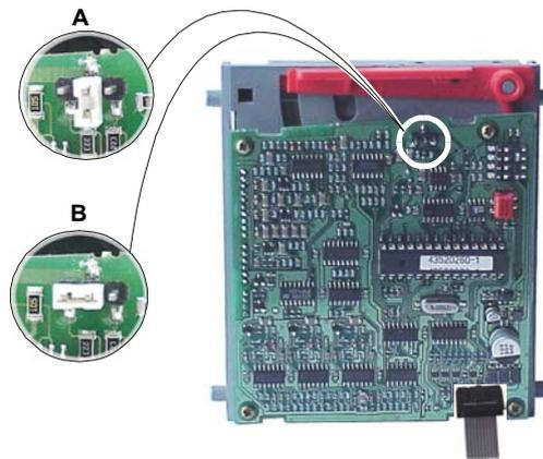
3. Conectar de nuevo el mazo de cables al conector J3 del *selector*. Ahora, hacer un puente eléctrico entre los pines central e izquierdo del conector J5 de 3 vías. Hecho esto, el electroimán del obturador del *Selector de monedas* actúa durante un breve espacio de tiempo; esta señal indica que el *selector* está en modo de auto-programación.
