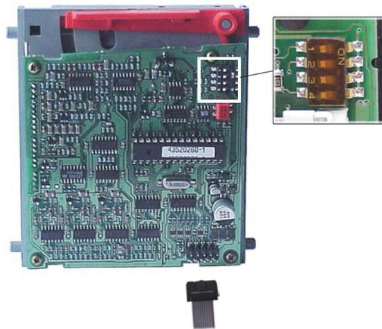
1. Soltar el mazo de cables del conector J3 del *selector*.
