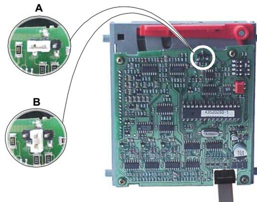
5. Ahora, retirar el puente colocado en el conector J5 de 3 vías. Hecho esto, el electroimán del obturador del *selector* actúa durante un breve espacio de tiempo; esta señal indica que el *selector* está programado con las nuevas monedas o fichas. Si en el proceso de auto-programación se produce alguna incidencia, no se producirá la activación de este electroimán.
